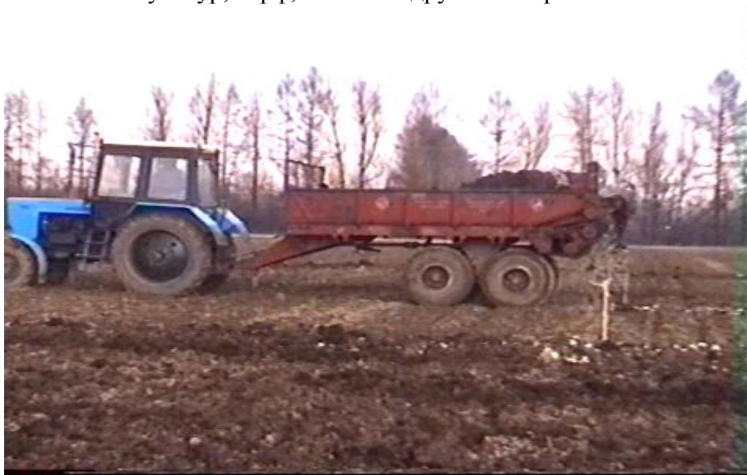
Рисунок 14 – Машина для внесения органических удобрений ПРТ-7
