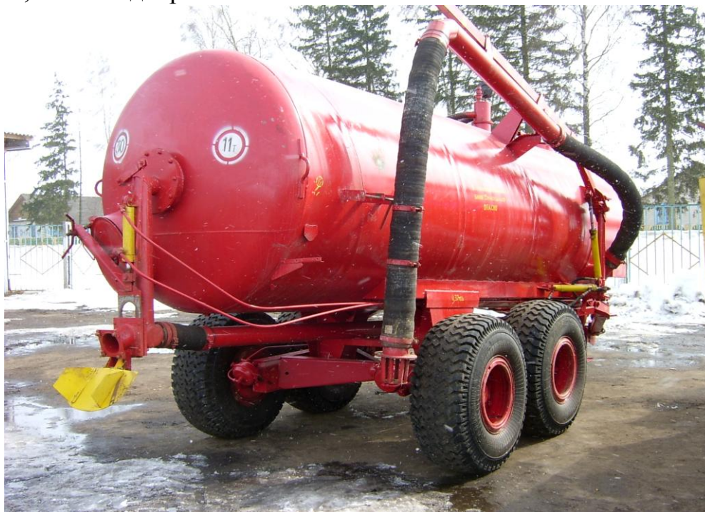
Рисунок 15 – Машина для внесения бесподстилочного навоза МЖТ-8
