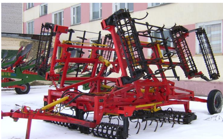
Рисунок 8 – Агрегат широкозахватный для предпосевной обработки почвы АКШ-7,2 (6,0; 3,6)
