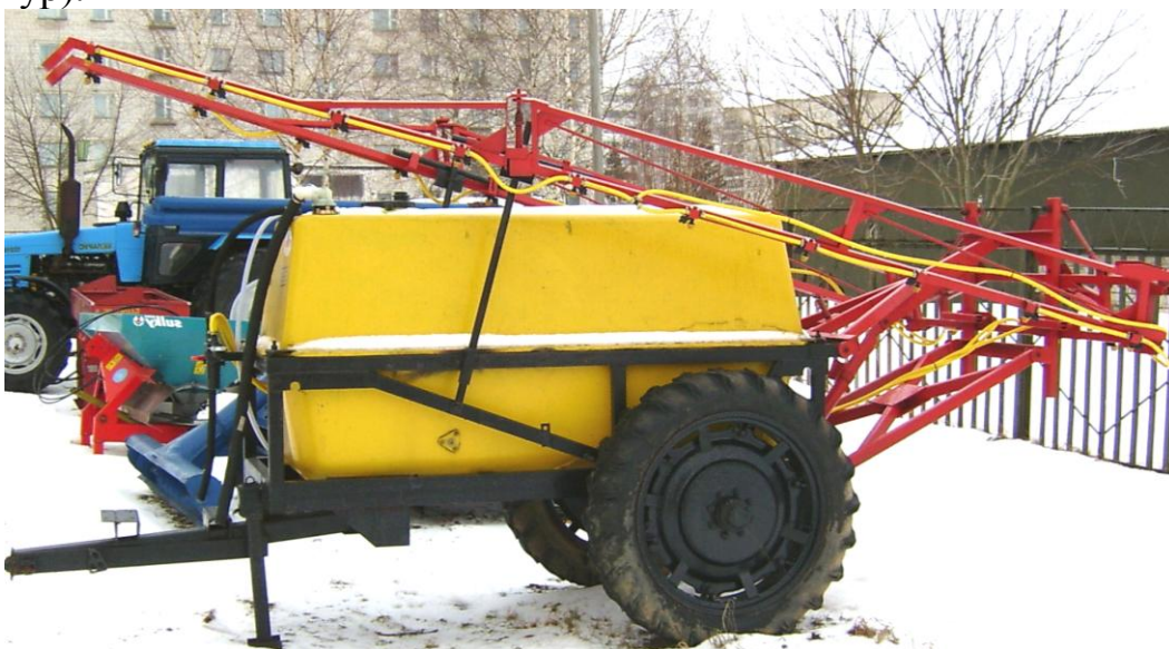
Рисунок 11 – Опрыскиватель штанговый ОП-2000
