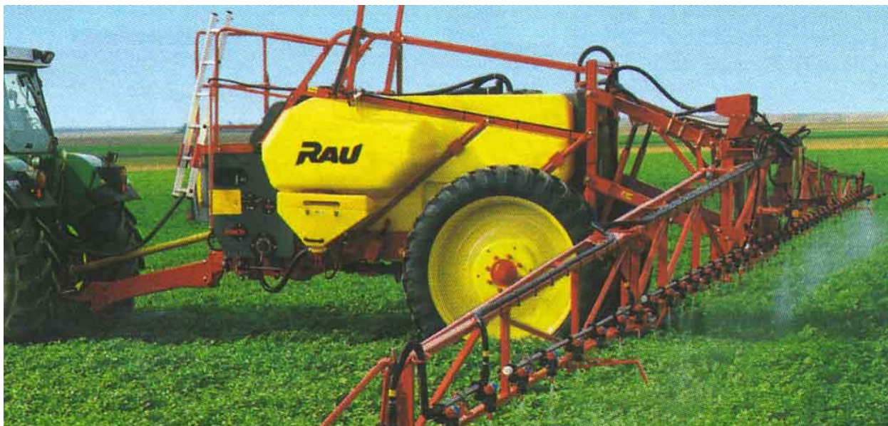
Рисунок 12 – Машина для внесения жидких минеральных удобрений
