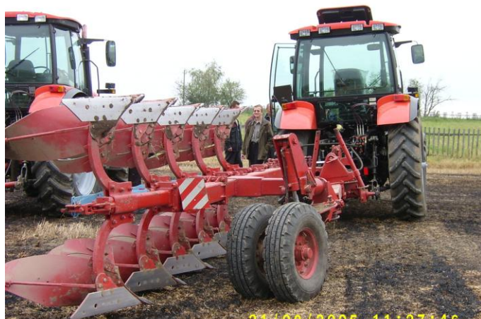
Рисунок 6 – Оборотный плуг Минского завода шестерен
