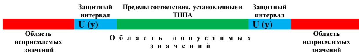
Рисунок 1 – Пример области допустимых значений, установленной с целью уменьшения риска производителя ( $U(y)$  – расширенная неопределённость)
