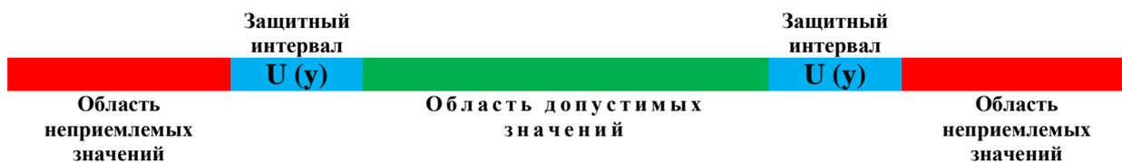
Рисунок 2 – Пример области допустимых значений, установленной с целью уменьшения риска потребителя ( $U(y)$  – расширенная неопределённость)
