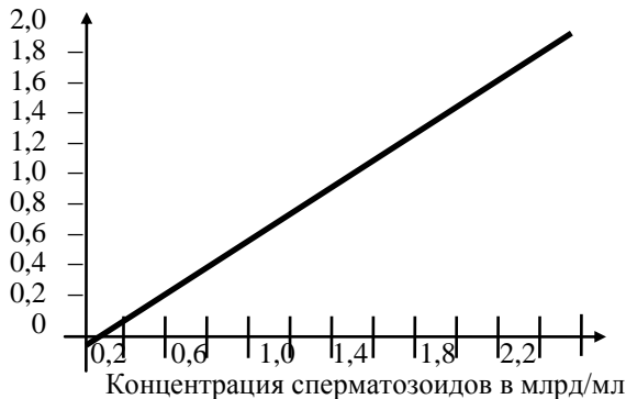
Рис. 3. Калибровочная кривая для определения концентрации спермы быков на фотоэлектроколориметре.
