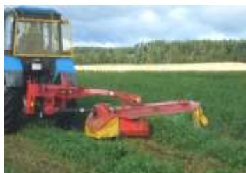
Косилка-плющилка навесная КРН-3,1 Рис. 3.2.1. Укладки скошенной массы в валок
