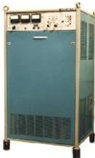
**Рисунок 1 - Ультразвуковая установка УЗГ-2-4М для обработки воды**
