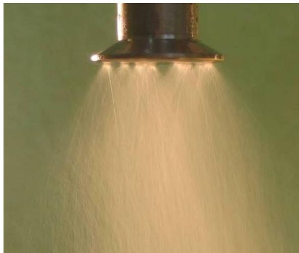
**Рисунок 2 - Процесс ультразвуковой обработки воды излучателем**
