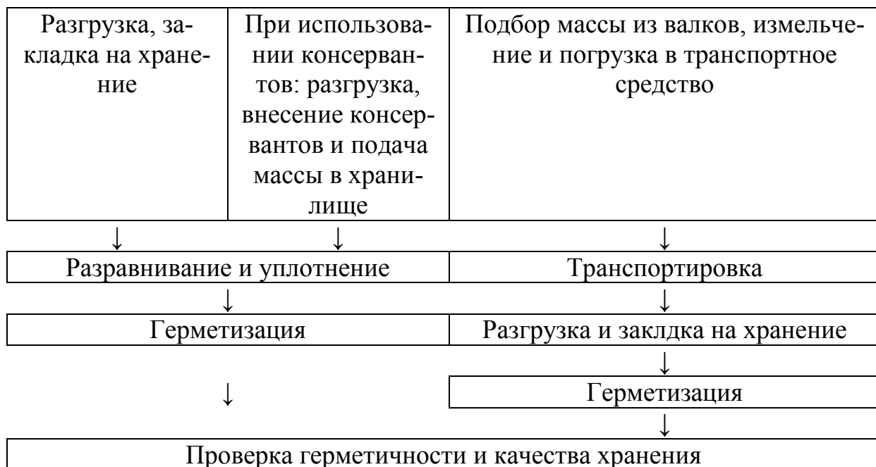
Рисунок 73 - Схема основных технологических операций при заготовке силоса
