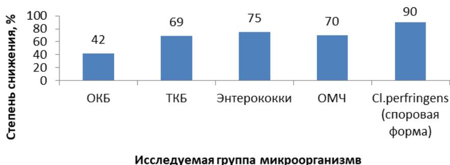
**Рисунок 2 – Степень инактивации бактерий при озонировании СВ в дозе 26 мг/дм<sup>3</sup>**
