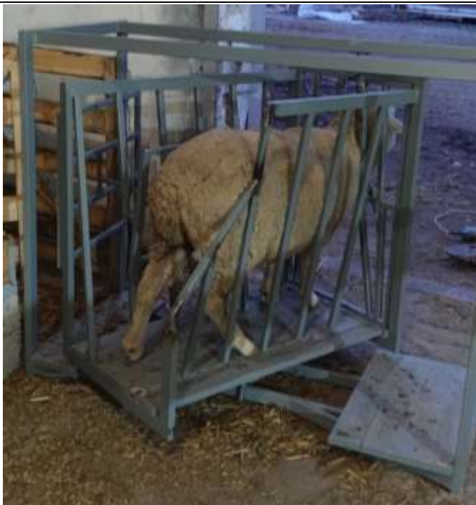
Рисунок 2 – Поворотный станок для искусственного осеменения овец в действии с механизмом фиксации задней части туловища
