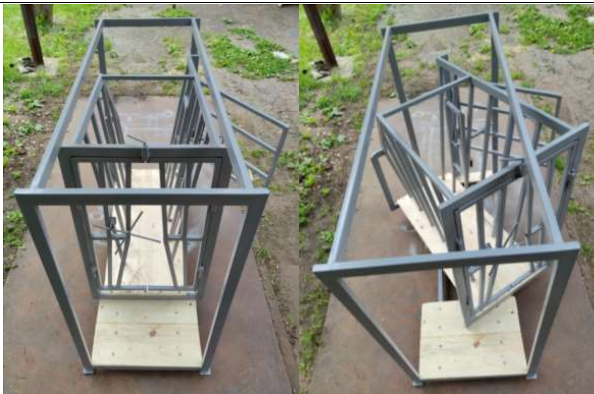
Рисунок 1 – Поворотный станок для искусственного осеменения овец
